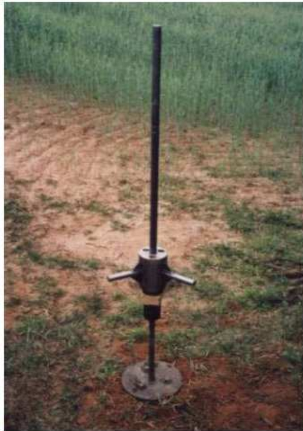
Figura 2-2 Equipamento DPL instalado no campo
